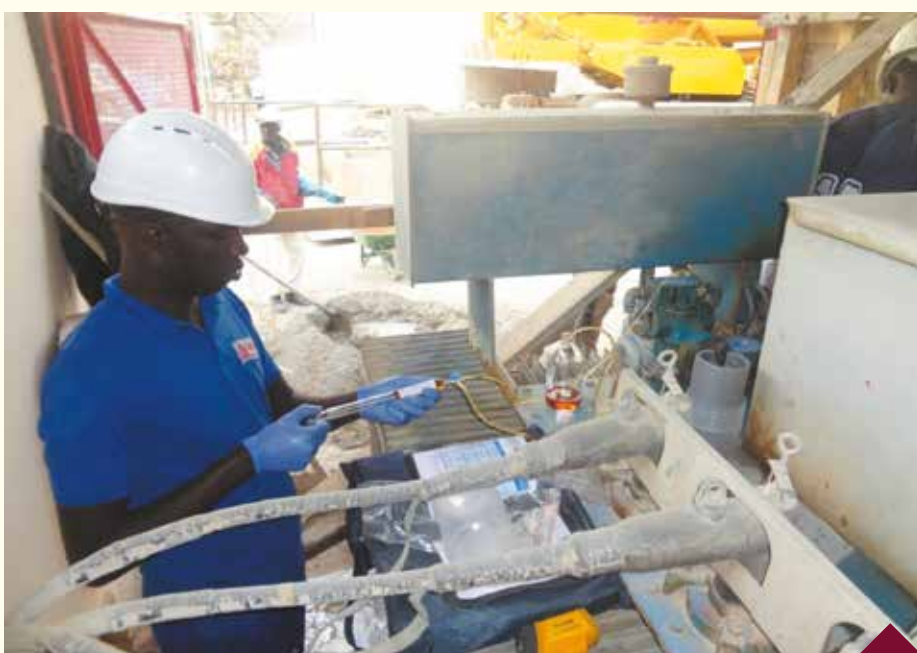
Prélèvement et analyse huile de 14 transfos CLIENT : ICS CHIMIE DAROU1.
