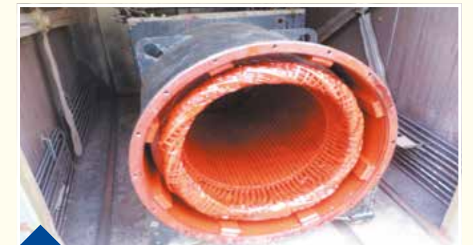
Etuvage polymérisation dans Four ventilé
