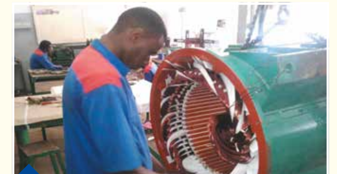
Rebobinage stator alternateur 2000KVA Client : Mine d'or ENDEAVOUR MINNING Mali
