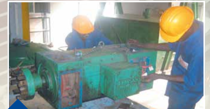
Démontage moteur Courant continu P : 179KW 1500TR/mn - CLIENT : SIBA
